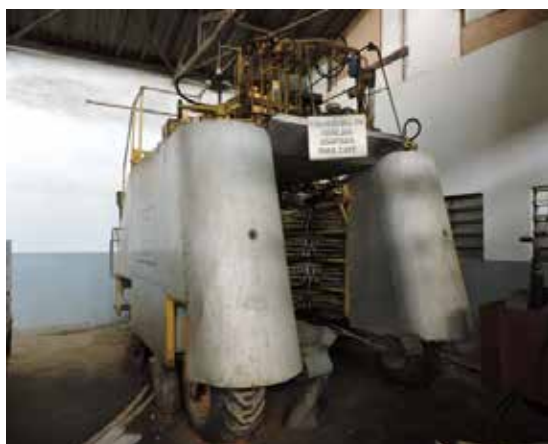
Foto 62: Primeira máquina colhedora de café, adaptada de uma máquina de colher cerejas. FONTE: Própria, 2016.
