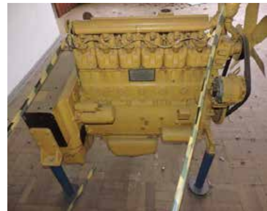
Foto 37: Motor D 225-6 de 1979 construído com peças refugadas e apenas para fins didáticos. FONTE: Própria, 2016.
