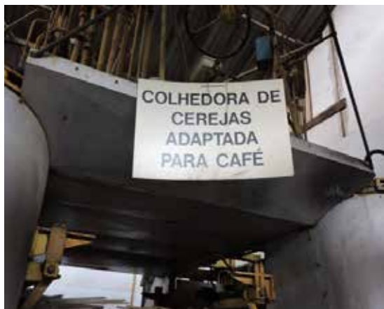
Foto 63: Primeira máquina colhedora de café, adaptada de uma máquina de colher cerejas. FONTE: Própria, 2016.
