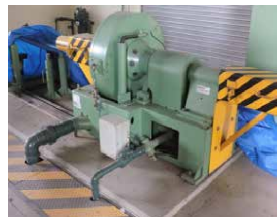
Foto 38: Máquina que realizava ensaios de regulação de freios nos tratores. FONTE: Própria, 2016.
