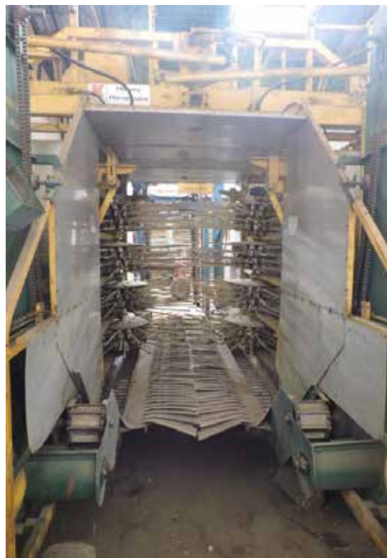
Foto 64: Primeira máquina colhedora de café, adaptada de uma máquina de colher cerejas. FONTE: Própria, 2016.
