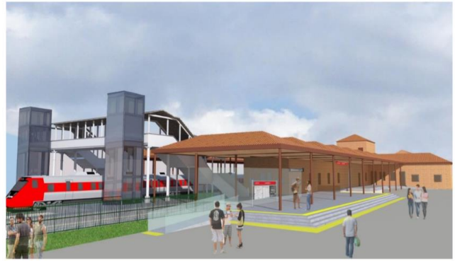
Figura 5 – Nesta vista externa da Estação, é possível identificar as novas implantações como: rampa de acesso ao corpo principal da Estação, Elevadores que se comunicam com a passarela histórica
