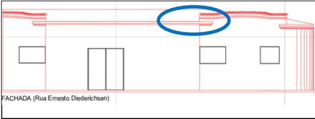
Detalhe ampliado da fachada no projeto. Na elipse em azul, detalhe da platibanda não executada.
